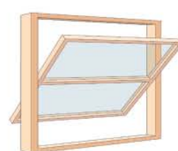
fenêtre F basculante horizontal pivoting window ventana F basculante Schwingflügel M finestra F a bilico M orizzontale
